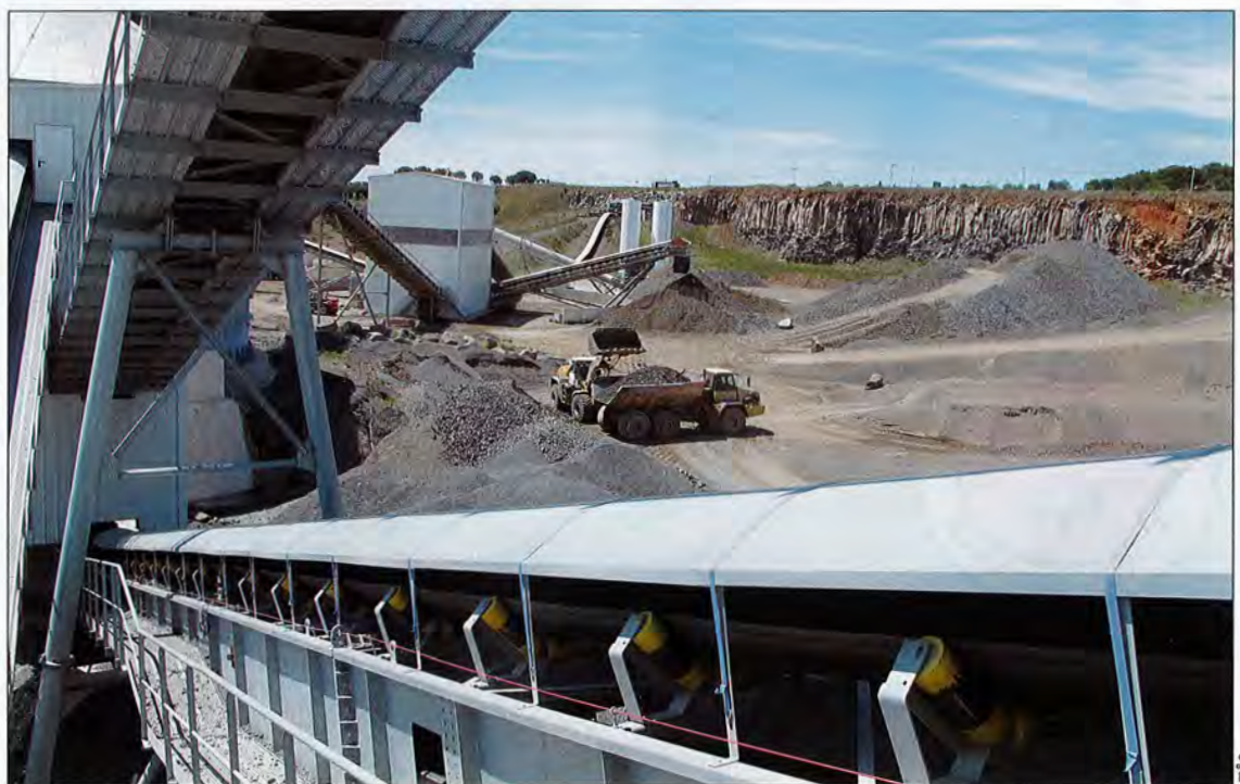
Installation de traitement secondaire-tertiaire de la Société des Carrières des roches bleues, et, au fond, la zone d'extraction sur le site de La Vière (34).
